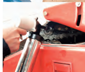
●フレキシブルノズルで狭い隙間の注油作業も楽々
