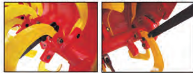
爪交換レンチ補助ハンドルの掛け方(使用例)
